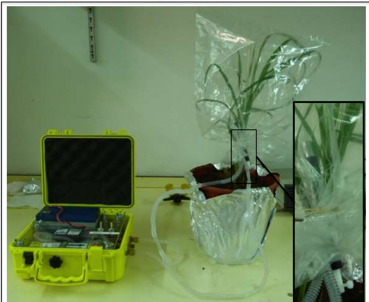
Figure 34 : Photo du piégeage des volatiles du plant de lemongrass par SPME (DVB/PDMS).
